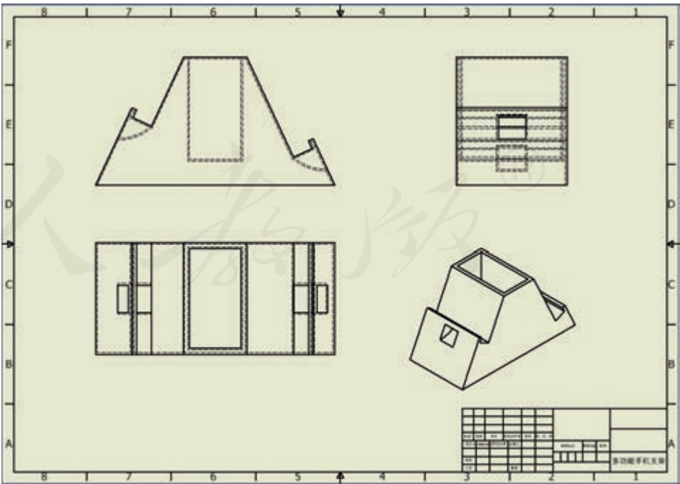
图3-43 多功能手机支架基础视图
